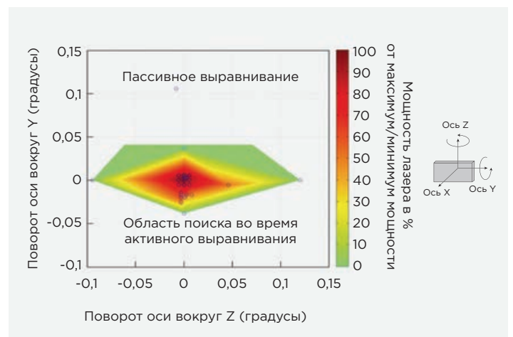
2 График зависимости мощности исходящего лазерного излучения от смещения зеркала [5]
