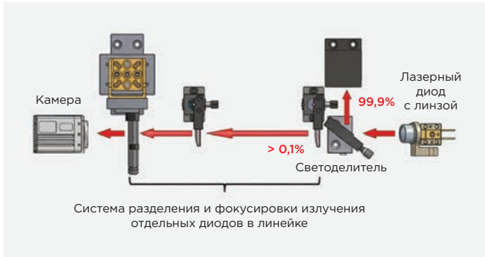
6 Схема модуля для проведения процесса активного выравнивания [7]
