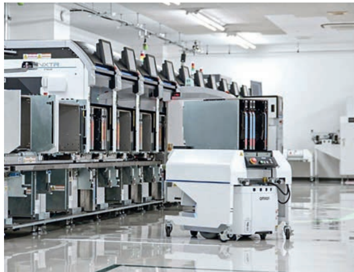
2 Оперативный автоматический подвоз новых питателей при помощи роботизированной тележки AGV
