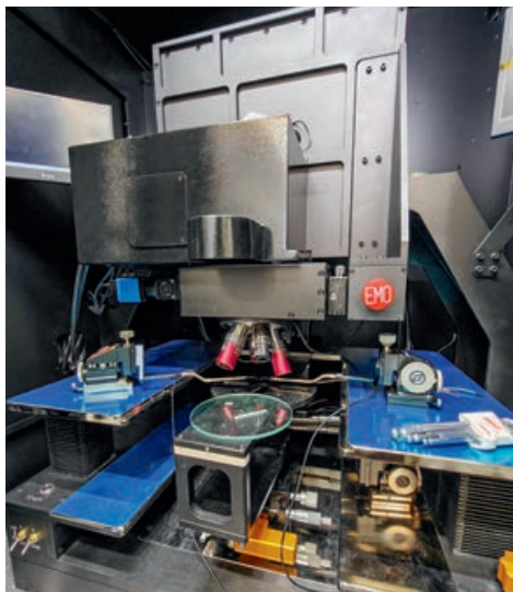
7 Внутренняя компоновка фотоэмиссионного микроскопа Nanometric PhotOn-10 (EMMI)
